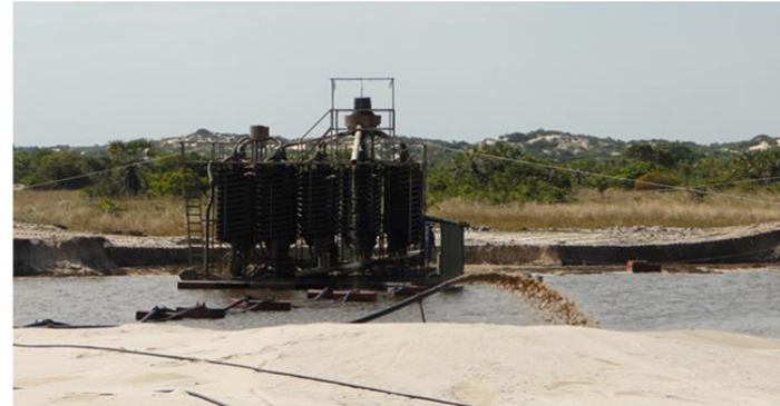
Reactores em funcionamento (lavagem das areias e separação dos metais por decantação).
